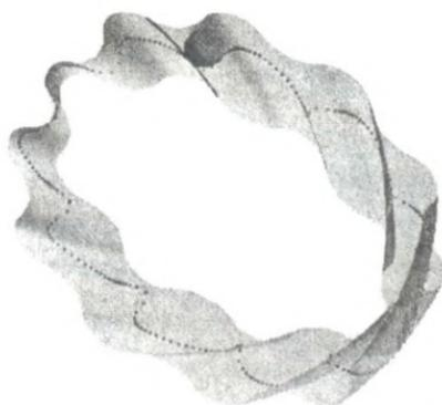
Рисунок 5 – Касание фрезы с выходной деталью. Показана координатная линия, которую будет выгнать фреза. Пунктиром показано множество точек контакта сферы с деталью, при всех значениях параметра  $\tau$ .
